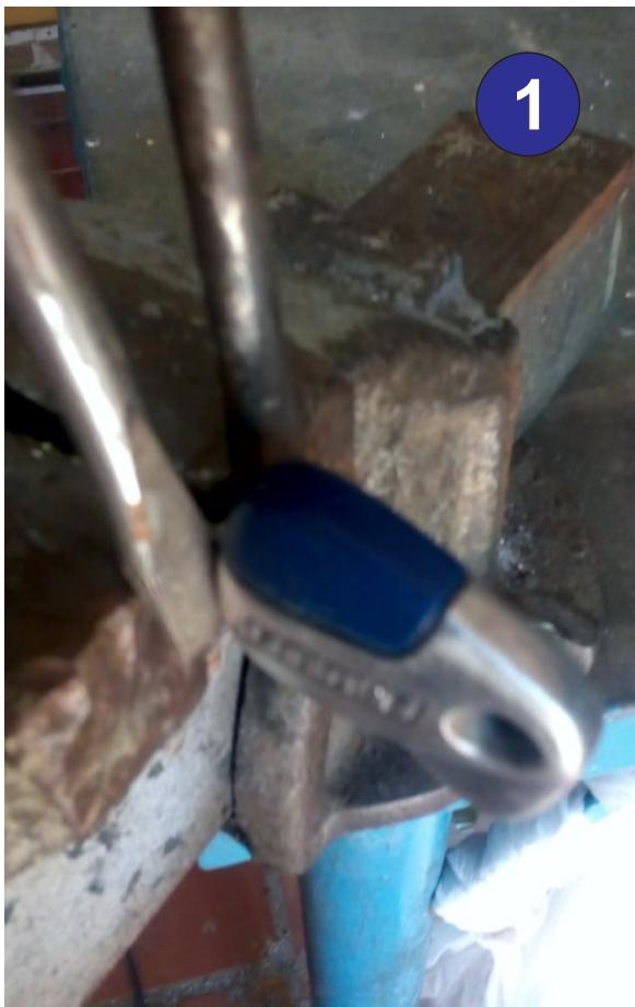
Para desmontar a chave de alumínio do Fiat Coupê, para troca de lâmina ou o transponder, é preciso antes prender a lâmina num torno e fazer uma alavanca com chave de fenda. (foto 1)
